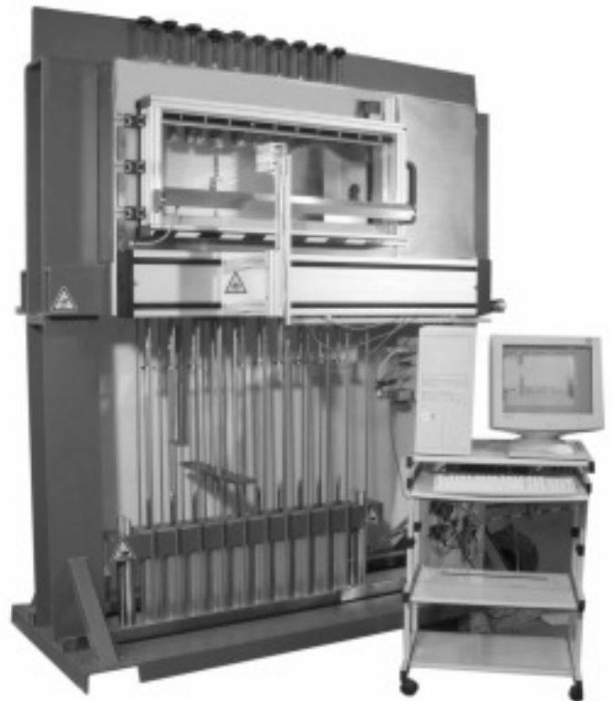
Coesfeld Materialtest Zeitstandsanlage mit Extensiometer
