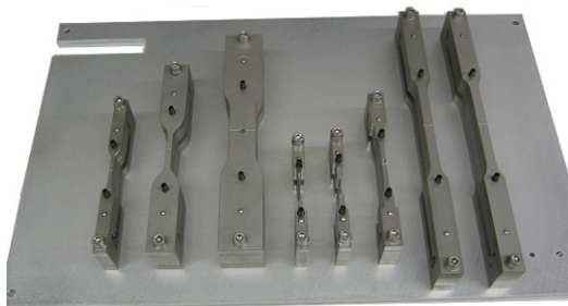
Spannzeug für Zugproben nach DIN EN 527
