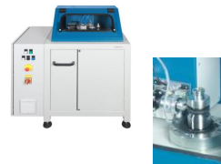
ICCA - Cut and Chip Erste instrumentierte Prüfmaschine zur Charakterisierung des Cut, Chip und Chunk Verhaltens.
